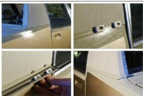
16. ábra: A II. típusú 3D nyomtatott alkatrészek a tető bőrborításának peremét takaró díszléc rögzítő
