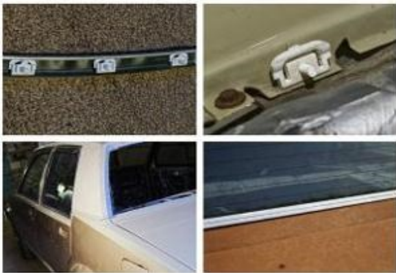
15. ábra: Az I. alkatrész 3D nyomtatott változatának beépítése és a segítségével rögzített hátsó szélvédőt
