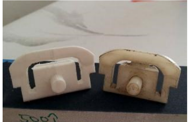
11. ábra: A baloldalon a nyomtatott, a jobboldalon az eredeti alkatrész [saját fénykép]
